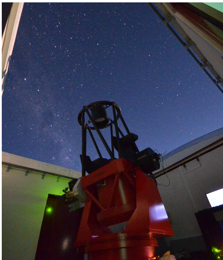
Rysunek 1.3: Teleskop 0,8m z kamerą podczerwoną IRIS. Autor: M. Ramolla
