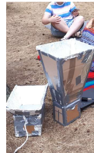
Izrađene rog antene pripremljene za probu.
